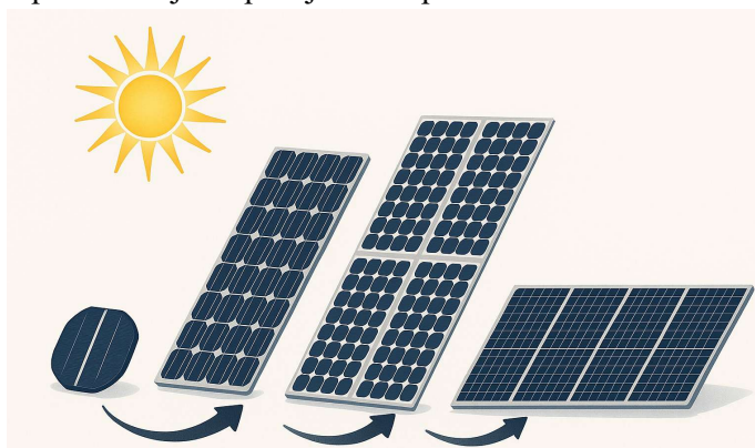
Slika 4.8. Fotonaponska ćelija, modul, panel i niz
